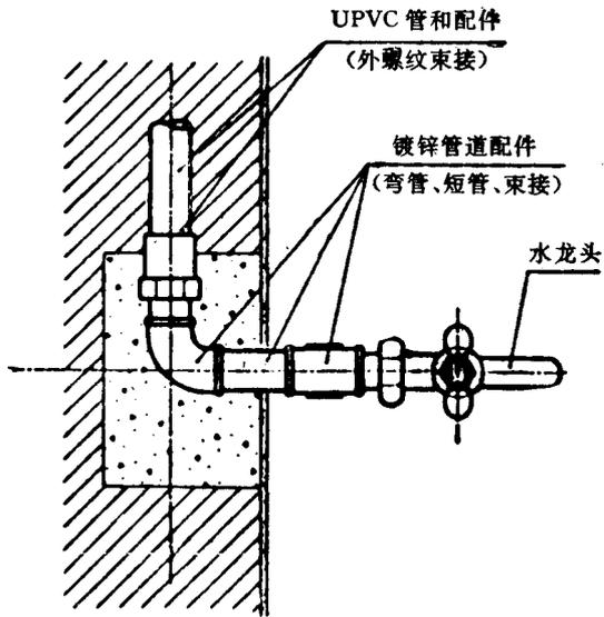
附图 1.6 系统末端用水器具安装 (嵌装)
