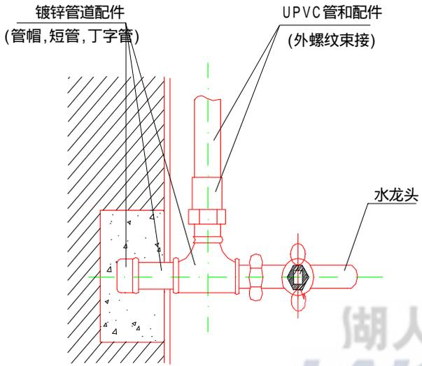
附图 1.4 系统末端用水器具安装 (明装)
