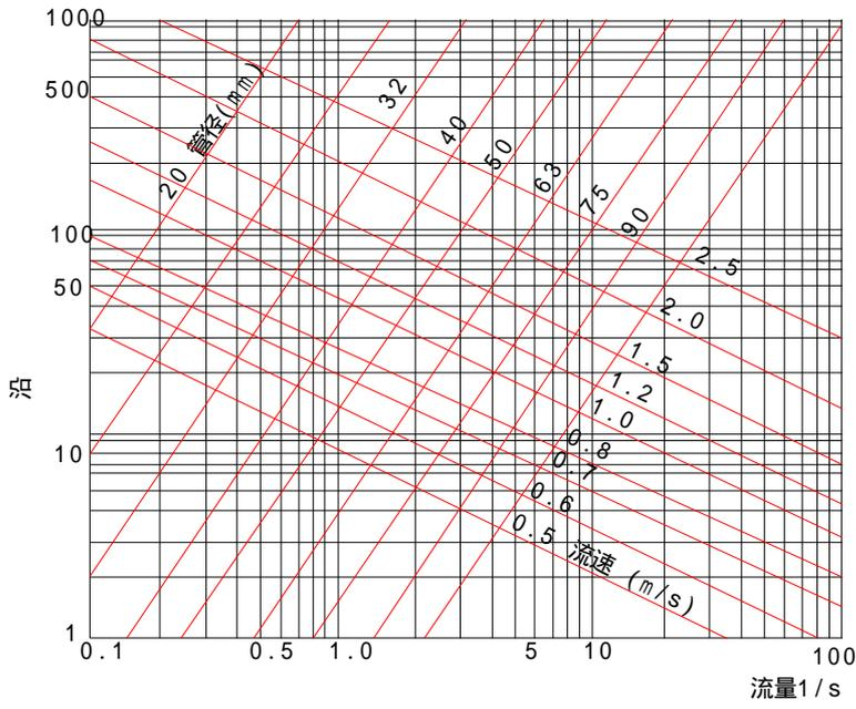
程 图 2.2.1 建筑给水硬聚氯乙烯管道水力计算图 (公称压力 1.0MPa)
